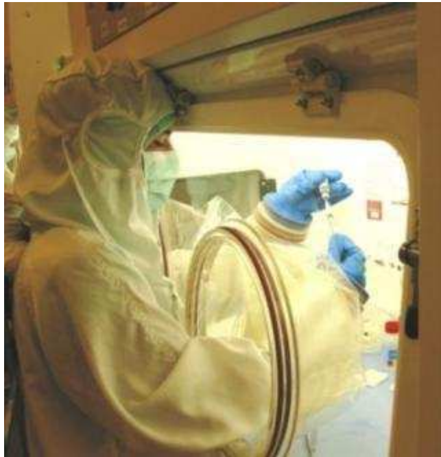
Figure 23: Production de préparations cytotoxiques à la pharmacie des HUG dans un poste de sécurité biologique de type 3
