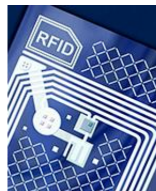
Puce RFID 2D. Source : site de l'Agence nationale de sécurité sanitaire de l'alimentation, de l'environnement et du travail
