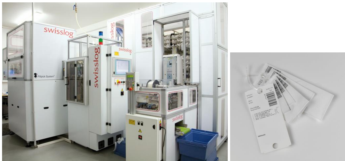
Figure 15: Système de dispensation individuelle : automate et anneau de médicaments (SWISSLOG) [193]
