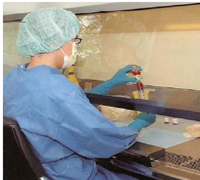
Figure 5 : Manipulateur sous flux d'air laminaire vertical
