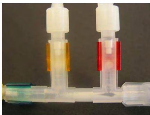
Figure 13 : formation de précipité dans la rampe
