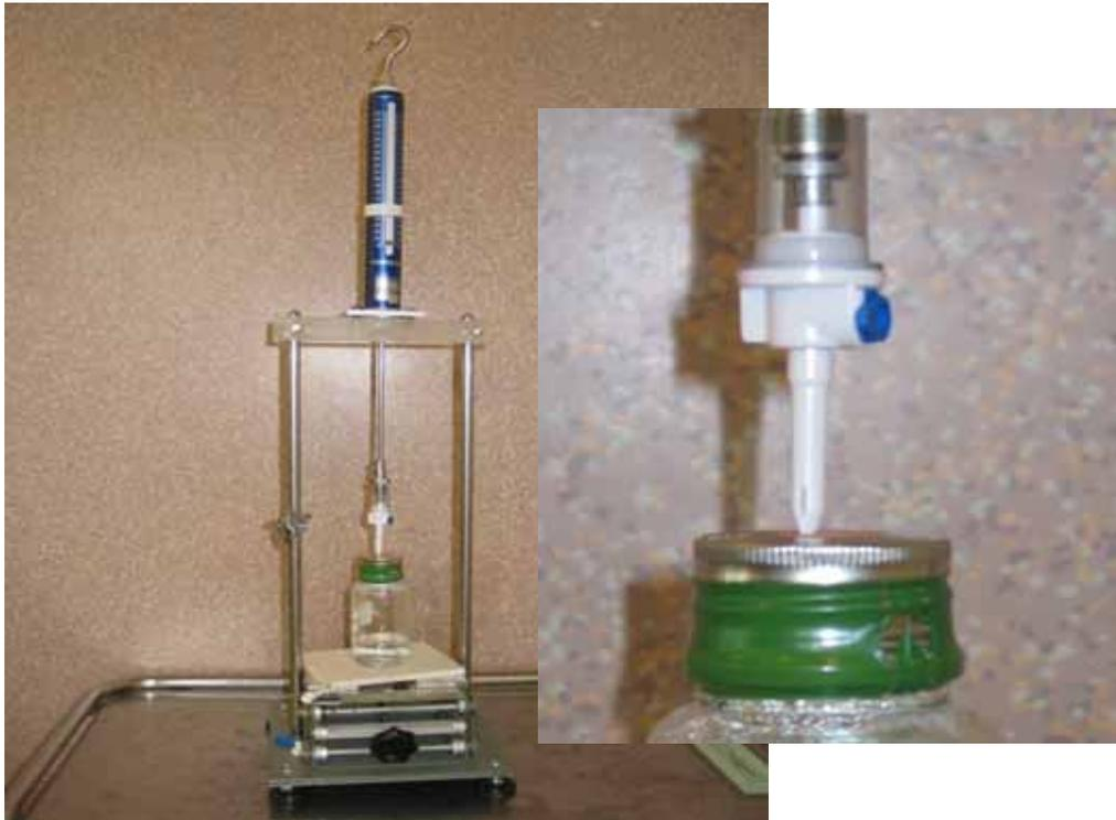
Figure 11 : Illustration du montage pour l'évaluation de la force de trocardage.
