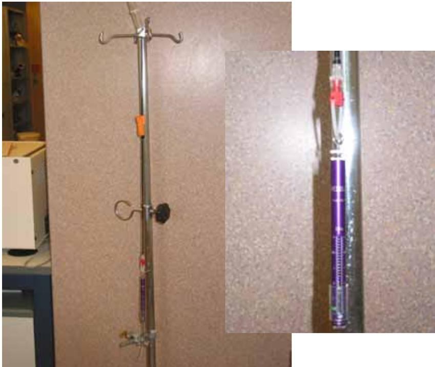
Figure 12 : Montage pour la résistance du raccord Luer
