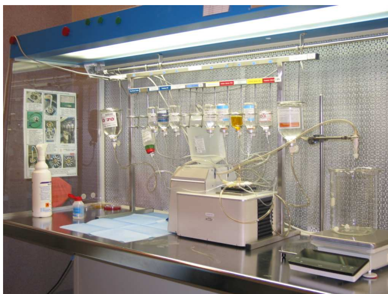
Figure 6 : automate Baxa MM12 prêt pour une fabrication
