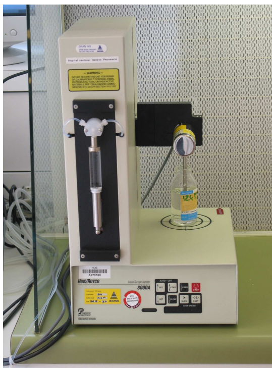
Figure 49 : compteur de particules Hiac/Royco
