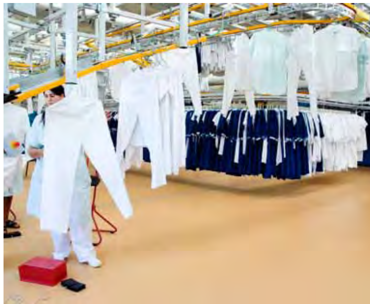
A la centrale de traitement du linge, les informations contenues sur la puce apposée à chaque vêtement sont lues à distance.
