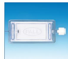
Ces deux filtres à 0.2 µm sont des filtres éliminateurs d'air, de particules, de bactéries **et** d'endotoxines. Ils sont conçus pour une utilisation maximale de **96 heures (4 jours)**. La membrane particulière de ces filtres (Posidyne) est chargée électriquement ce qui permet de retenir les endotoxines.
